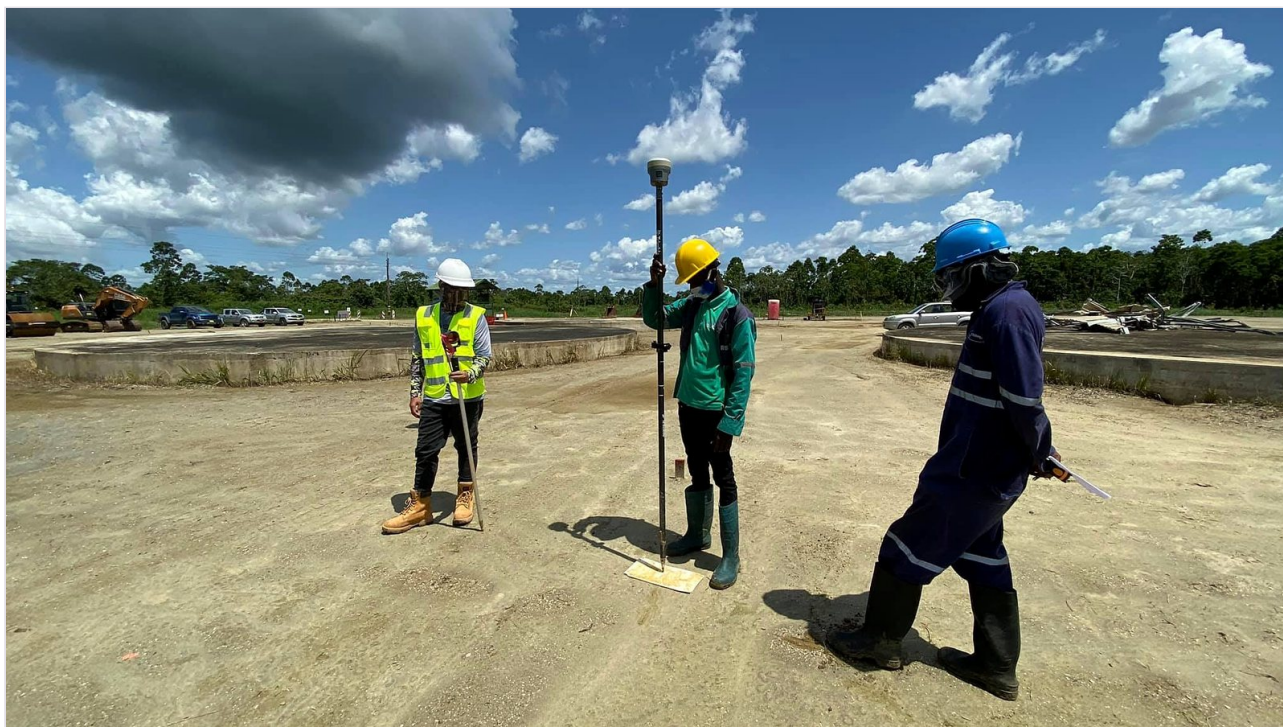
Inmeten met GNSS in het veld.
